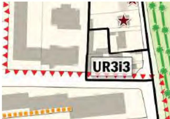
Les nouvelles règles sont un coefficient d'emprise au sol un maximum de 40%, une surface de pleine terre d'au moins 50% de la surface du terrain et une règle de hauteur parenthèses (indice 3) de R+2+C.
